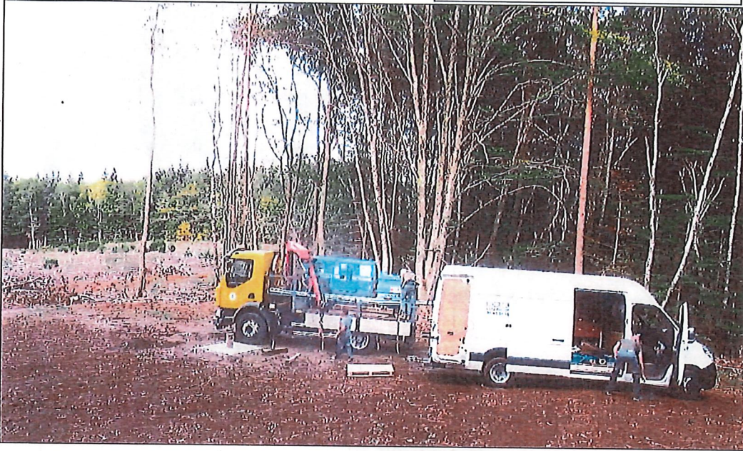
Installation du matériel pour les essais de pompage (matériel de pompage et groupe électrogène)
