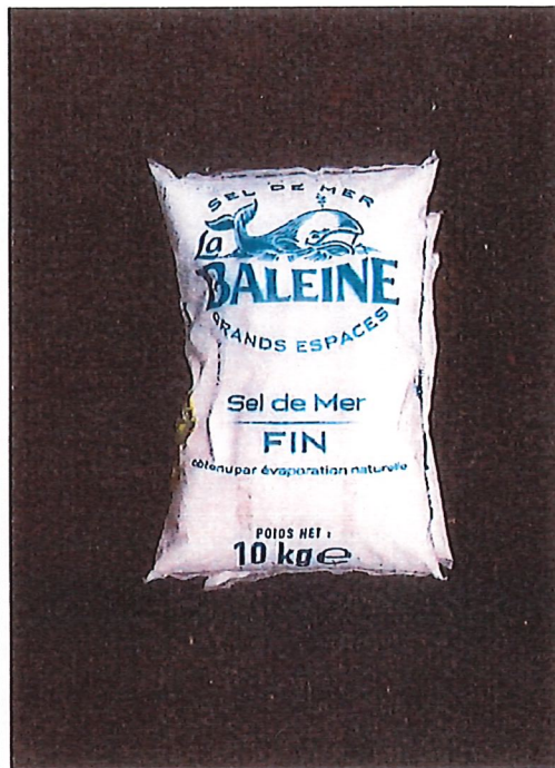
Traçage au sel au droit du rejet (50 kg) afin de s'assurer de la non réalimentation des eaux exhaurées
